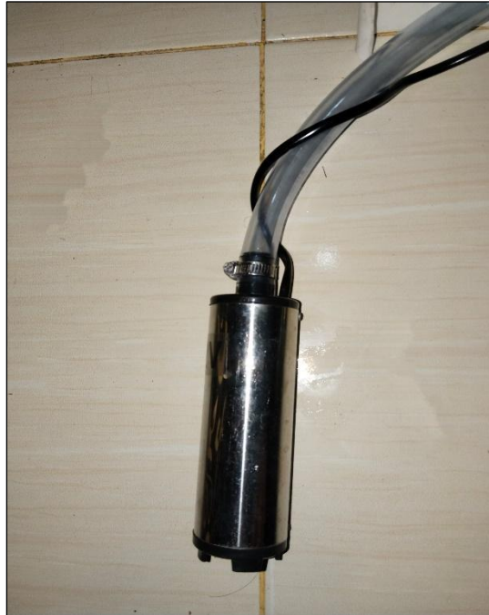
Gambar 6.2 Pompa DC 12 Volt pada Pompong Nelayan
