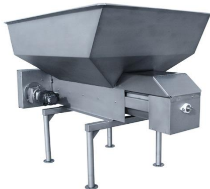
Gambar 17. Hopper atau reservoir dan sistem metering
