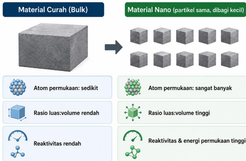
Gambar 5.1 Ilustrasi Konseptual Peningkatan Rasio Luas Permukaan Terhadap Volume Saat Material dibagi Menjadi Partikel Skala Nano dengan Volume Total yang Sama
